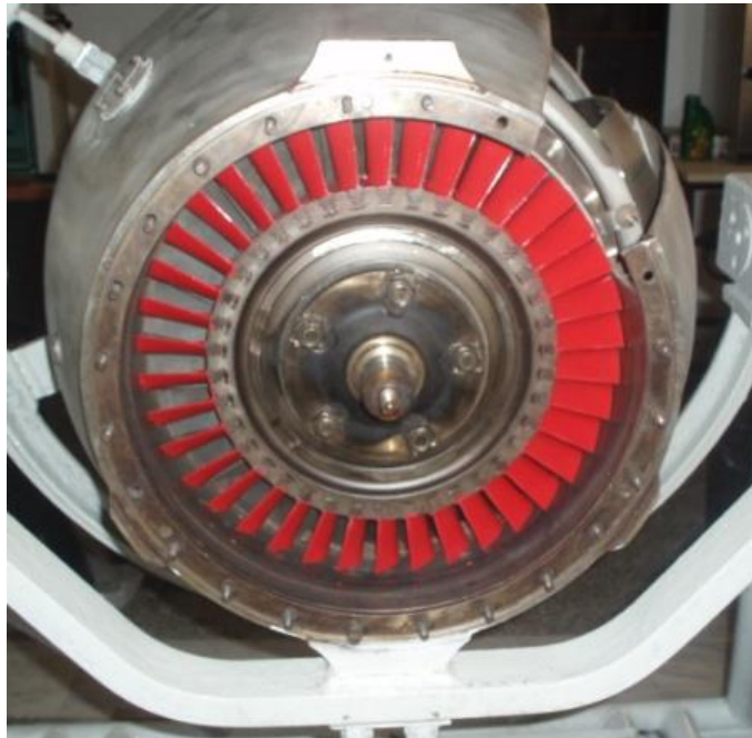
Σχήμα 3.14. Στρόβιλος κατόπιν βαφής
