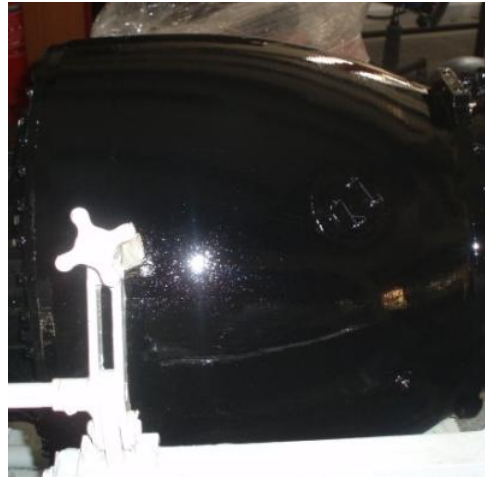
Σχήμα 3.16. Περίβλημα στροβίλου – θαλάμου καύσης κατόπιν βαφής
