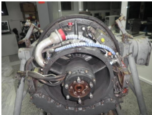
Σχήμα 3.3. Συγκρότημα κιβωτίου παρελκομένων ρυθμιστή καυσίμου, αντλίας καυσίμου και λαδιού
