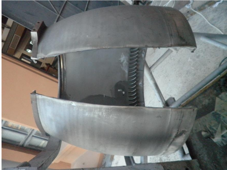
Σχήμα 3.11. Τομή περιβλήματος στροβίλου - θαλάμου καύσης
