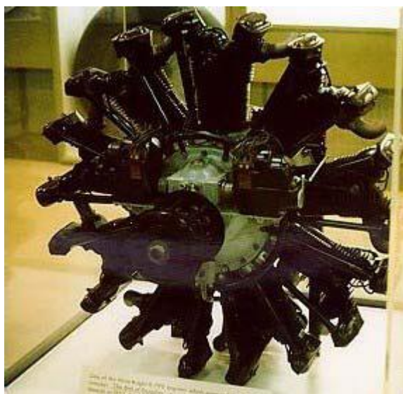
Σχήμα 2.6 Κινητήρας Wright R-790
