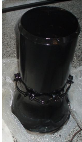
Σχήμα 3.18. Αγωγός καυσαερίων κατόπιν βαφής
