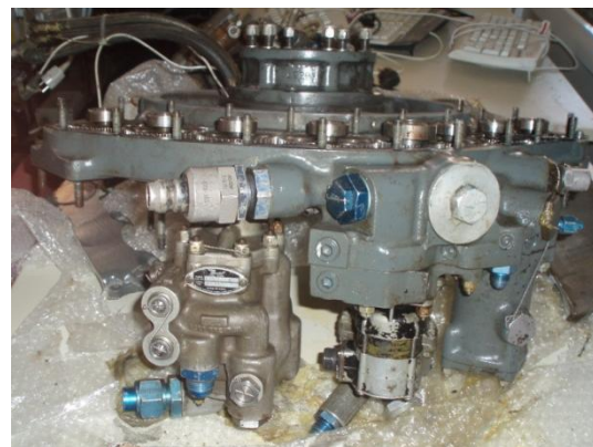
Σχήμα 3.3. Συγκρότημα κιβωτίου παρελκομένων ρυθμιστή καυσίμου, αντλίας καυσίμου και λαδιού
