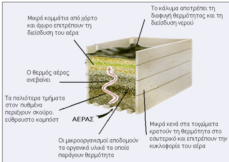
Σχήμα 3.12: Διεργασία κομποστοποίησης των οργανικών αποβλήτων [USEPA, 1996].
