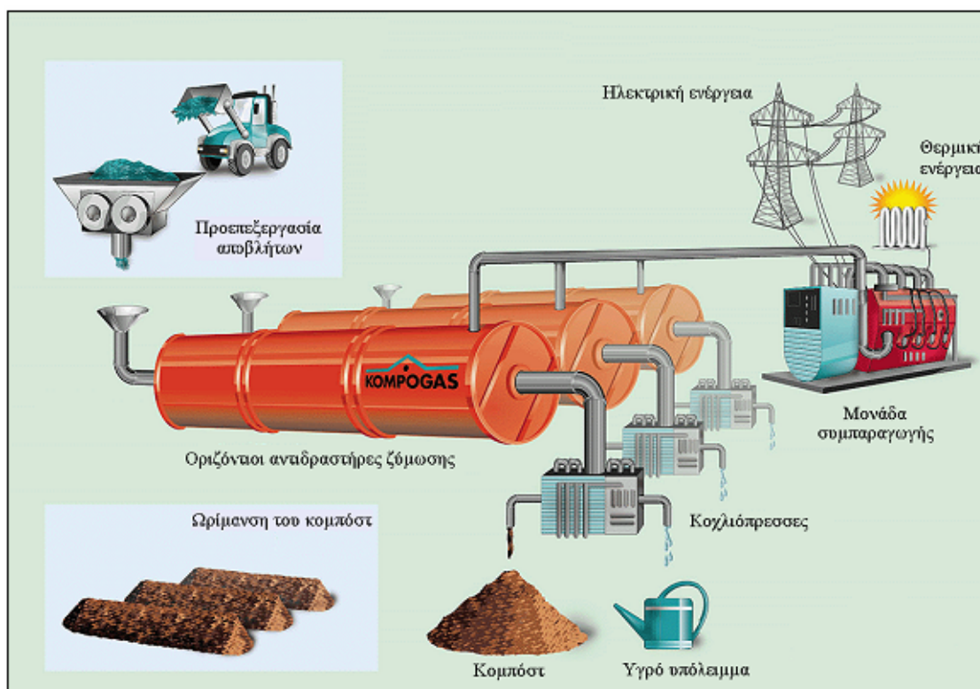
Σχήμα 3.10 : Διάγραμμα ροής της διεργασίας Kompostogas [www.kompostogas.ch].
