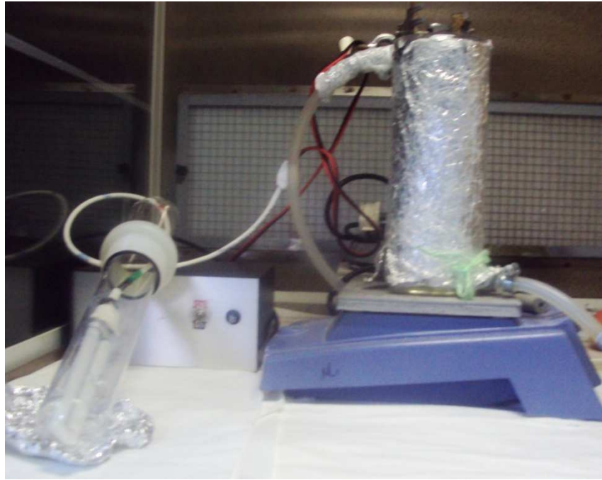
Εικόνα 5.2: Πειραματική διάταξη απολύμανσης με UVC ακτινοβολία.
